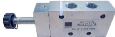
Alumínium szelep 720 óra után sópermet kamrában
