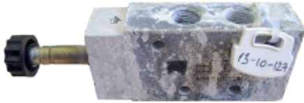
Rozsdamentes szelep 720 óra után sópermet kamrában
